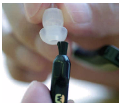
付属の掃除用ブラシを使って音の出口を下に向けてブラッシングします。
